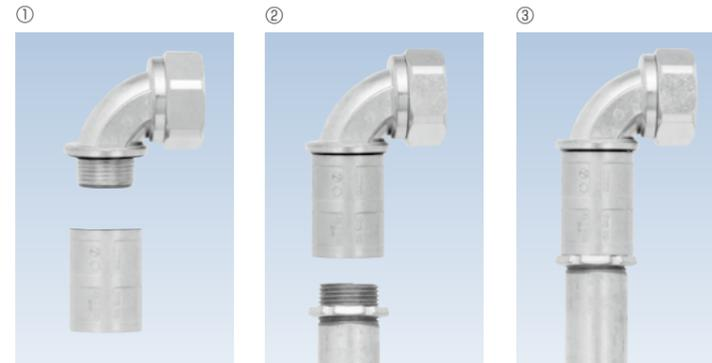
① 90° または 45° 形コネクタのロックナットを外し、鋼製電線管用カップリングをフランジに当たるまでしっかりとねじ込む。
