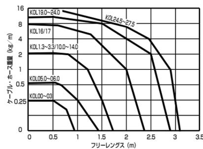
※この能力線図は限界線を表していますので能力線に近いところで使用しますと、使用条件によっては早期にたわみが発生する場合がありますので余裕(10%程度)をみて選定して下さい。
