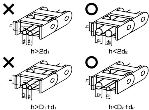
(2) ケーブルを複数本布設する場合で乗り上げが発生する場合はケーブル同士の擦れ、捻じれによる断線防止のため仕切板で分割・整理して下さい。
