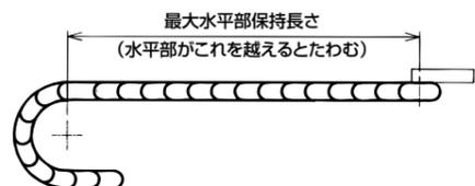
可能であれば、上側パワーゴジラのたわみを防止するため、樹脂製パワーゴジラはスライド板又は、スライドレールで面支持します。
