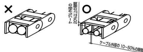
(5) ケーブルに対して、パワーゴジラが広すぎるとケーブルが蛇行するため仕切板で適切な幅にして下さい。
