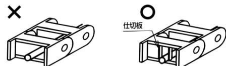
(6) パワーゴジラの外幅が 200mm 以上で収容ケーブルの本数が多い場合は質量バランスを考慮して左右対称に配置します。この時、質量の重いケーブルは端に配置して軽いものは中央に配置します。また、質量だけでなくケーブルの種類によって曲げに対する反発力が個々に違うため種類の同じものを対称に配置することも重要です。
