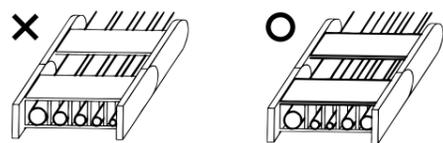
(7) ケーブルの布設時、張力を取り除き曲がり部分に余裕をもたせるようにして下さい。(適切な長さで布設します。)
