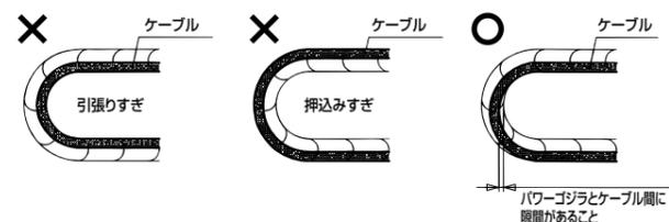
(8) ケーブルは固定端及び移動端で治具等により固定して下さい。
