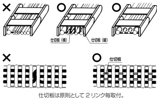
(3) 外径が大きく異なるケーブルを混在・隣接させないようにして下さい。
