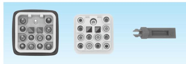
●12ZDD のオス、メスインサート勘合側にコーディングピンを2個ずつ差込んで使用し、三角形の凸部の勘合する向きを合わせることで、16通りの組合せを作ることができます。
