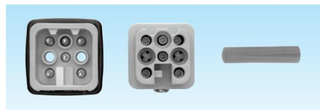
●ZD/D/DD のメスインサート勘合側に差込んで使用し、隣接するコネクタの誤接続を防止するための樹脂製のコーディングピンです。この場合、オスインサートの相対するコンタクト位置にはオスコンタクトを使用しないことで完成します。
