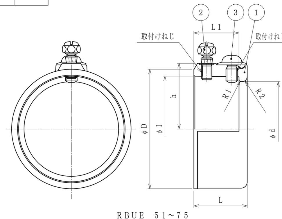
注1. ねじなし電線管/薄鋼電線管の末端に取り付ける、小ねじ止め式
