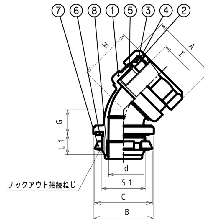
注1. ビニル被覆ケイフレックスをボックス類のロックアウトに接続するための、45°形の管用平行ねじ付き亜鉛合金ダイカスト製コネクタです。
