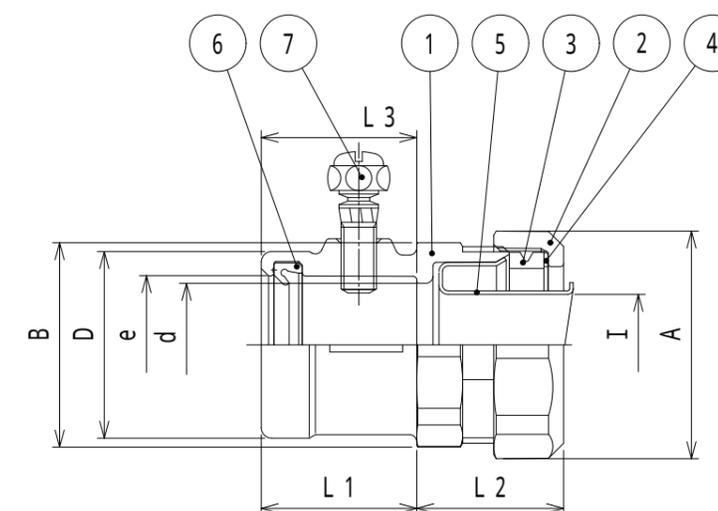
注1. ビニル被覆ケイフレックスをねじなし電線管/薄鋼電線管に接続するための、
