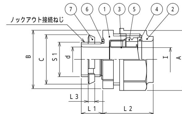
注1. ビニル被覆ケイフレックスをボックス類のロックアウトに接続するための、ストレート形の薄鋼電線管ねじ付き樹脂製コネクタです。
