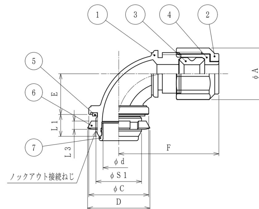
※C29BG1616はケーブルφ14からφ16のケーブルを使用する場合、通線しにくい場合は接続ねじ部の内径を通過する部分のケーブルは、被覆を剥ぎ取って挿入して下さい。
