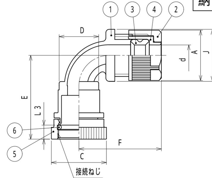
注1. ケーブルをバックシェル(又はプラグ)なしのMSコネクタ接続するための、90°形の樹脂製カップリングです。
