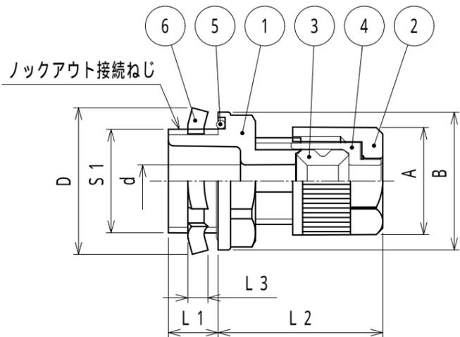
注1. ケーブルをボックス類のロックアウト又はリミットスイッチ等のめねじに接続するための、ストレート形の管用平行ねじ付き静電気防止樹脂製シールコネクタです。
