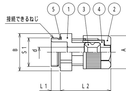
注1. ケーブルをフード・ハウジング等のPgめねじ(DIN規格)に接続するための、ストレート形のPgめねじ付き樹脂製シールコネクタです。
