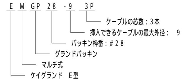
3. C型, C2型, E型, E2型コネクタ及びカップリングのグランドパッキンと交換して使用できます。
