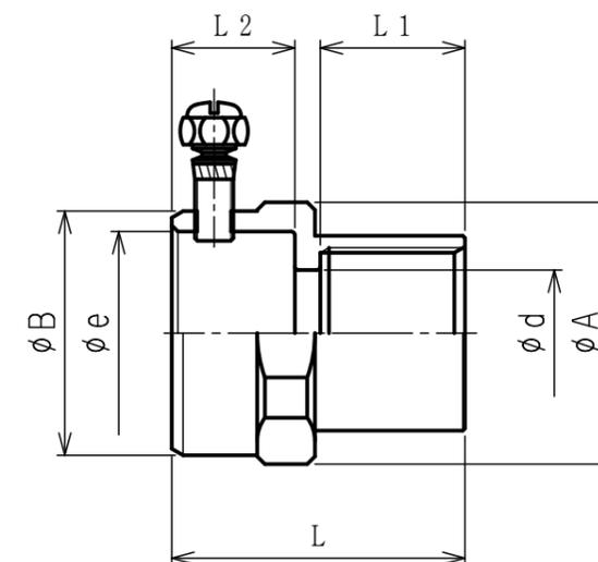
注1. プリカチューブをねじなし/薄鋼電線管に接続するための、ストレート形の亜鉛合金ダイカスト製小ねじ止め式コンビネーションカップリングです。
