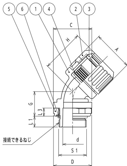
注1. サンフレキROBOをリミットスイッチ等のめねじに接続するための、45形の管用平行ねじ付きのコネクタです。
