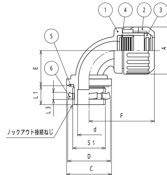
注1. サンフレキROBOをボックス類のロックアウトに接続するための、薄鋼電線管ねじ付き90形コネクタです。
