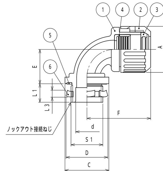
注1. サンフレキROBOをボックス類のロックアウトに接続するための、90形のNPTねじ付きのコネクタです。
