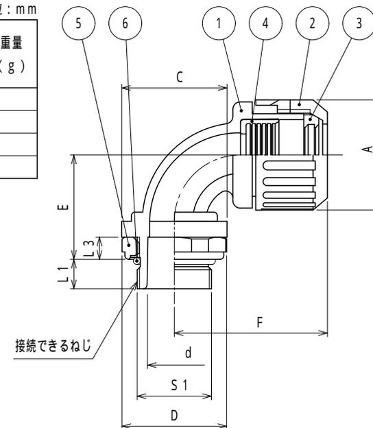
注1. サンフレキROBOをボックス類のロックアウトに接続するための、90形のメートル細目ねじ付きのコネクタです。
