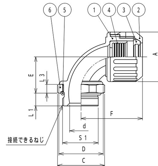
注1. サンフレキROBOをフード・ハウジング等のPgめねじに接続するための、
