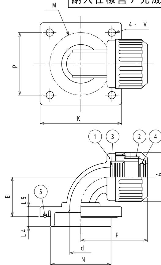
注1. サンフレキROBOをボックス類の穴に接続するための90形のフランジ付コネクタです。
