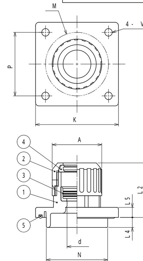
注1. サンフレキROBOをボックス類の穴に接続するためのフランジ付コネクタです。
