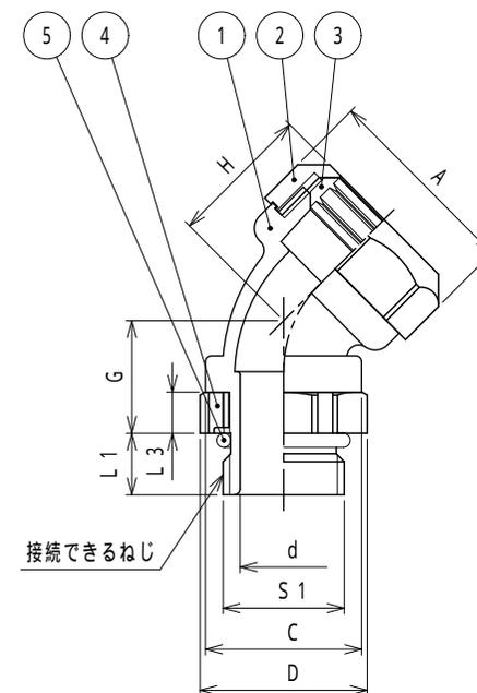
注1. サンフレキROBOを電気機器等のめねじに接続するための、45形の
