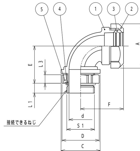
注1. サンフレキROBOをリミットスイッチ等のめねじに接続するための、90形の管用平行ねじ付きコネクタです。
