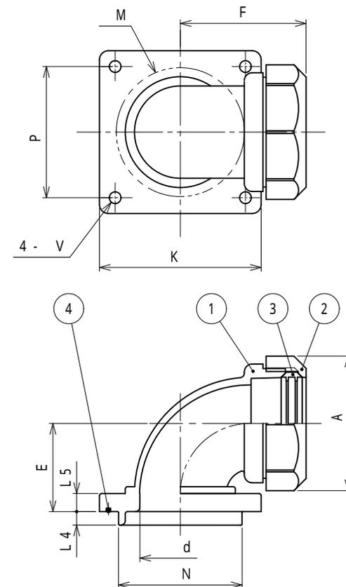
注1. サンフレキROBOをボックス類の穴に接続するための90 形のフランジ付コネクタです。
