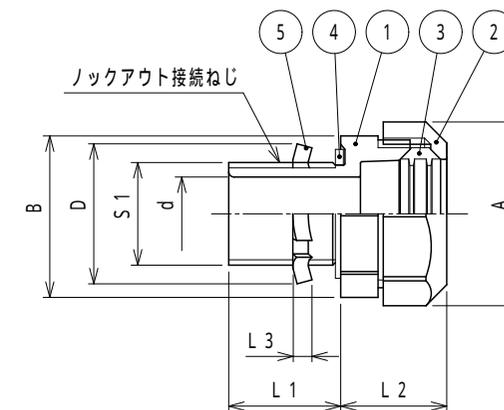
注1. サンフレキROBOをボックス類のロックアウトに接続するためのストレート形の管用平行ねじ付きのねじ長コネクタです。
