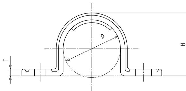
注1. サンフレキROBO / NTを造管材に固定するための、センター止めサドルです。
