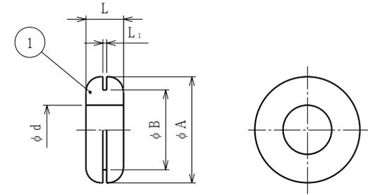
注1. 管用平行ねじ用/薄鋼電線管ねじ用のノックアウトに取り付けるための膜なしのグロメットです。
