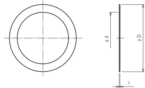
注1. コネクタをボックス類に接続する時に使用する，鋼製のワッシャです。
