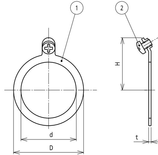
注1. コネクタをボックスに接続する時にアース線用として使用します。
