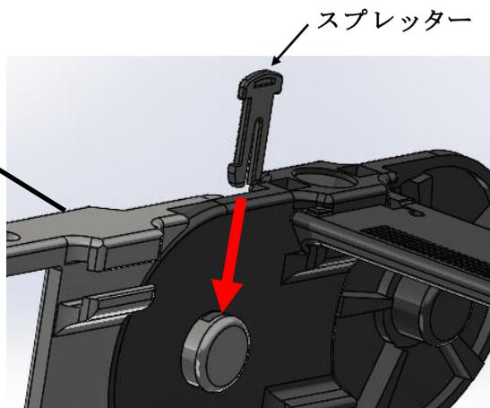
③フランジパーツ穴側はリンクの接続軸に嵌め、スプレッターを図のように差し込みます。
