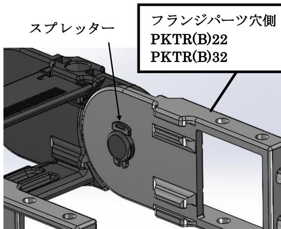
④ステーをストッパー側から矢印の方向にフランジパーツの T 溝部分にはめ込みます。通常は手で挿入できますが、入りが悪い場合はプラスチックハンマー等で軽い衝撃を加えて挿入します。
