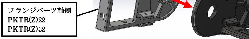
②フランジパーツ軸側はリンクの接続穴に嵌め、スプレッターを図のように差し込みます。
